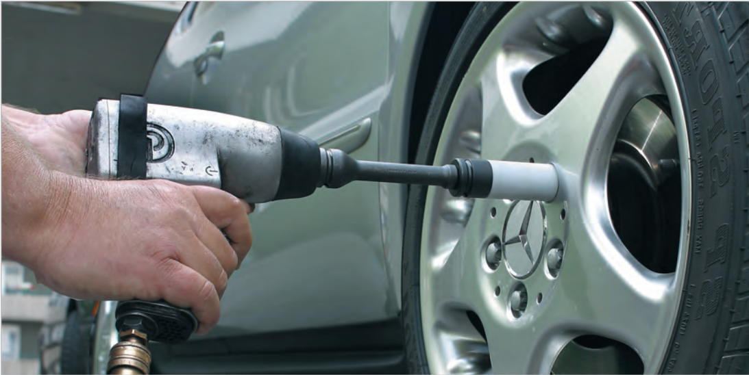
No 2309K 例如配有塑料保护套的1/2" 车轮螺母套筒 (规格: 17, 19和 20.8 mm), 特备适合敏感合金车轮。
